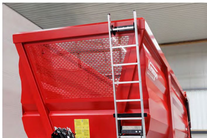
Schräge Stirnwand mit großem Sichtfenster – die Ladung immer im Blick.
