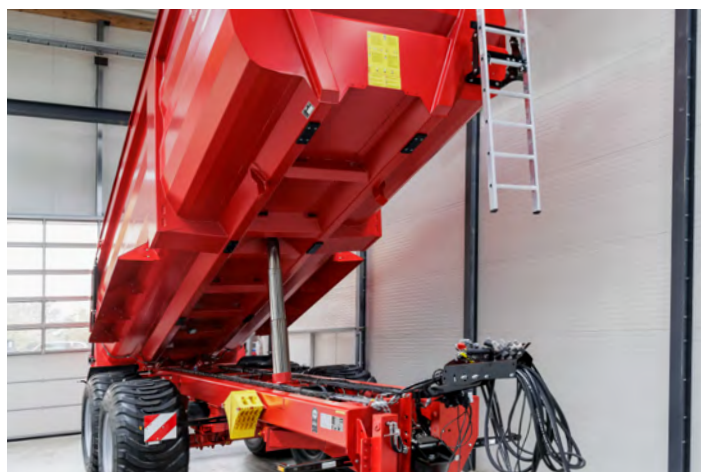
Neue und innovative Konstruktion der Wannenunterzüge.
