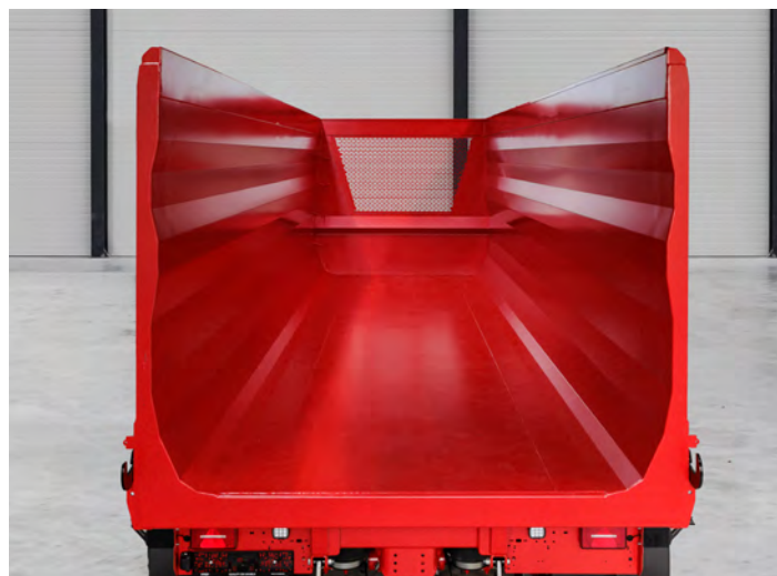
2 m hohe Wannenkonstruktion – korndicht und stabil.
