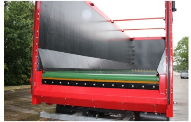
Die schwarze Antihaft-Beschichtung (2-Komponenten-Keramik-Kunststoffbasis) verhindert das Anhaften von schwierigem Ladegut.
