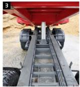
Die Entwickler von Krampe schafften es, trotz höherer Sattelplatte und Rahmen, den Hänger nicht höher als seinen Tandemkollegen (Big Body 750) zu konstruieren. Und das mit der serienmäßigen Luftfederung! Möglich macht die niedrige Plattformhöhe eine kompakte Bauweise des Fahrwerks mit gekröpften Federn und den daraufliegenden Luftbälgen (siehe Bild 3 auf Seite 3).
