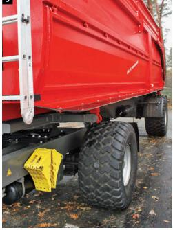
Mit den 60-cm-Aufsätzen wird das Auskippen für mittlere Frontladergrößen zum Problem. Große Rad- oder Teleskoplader müssen ran.
