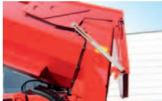
Besandungsleiste zum Begrenzen des Pendelweges der hydraulisch öffnenden Heckklappe.
