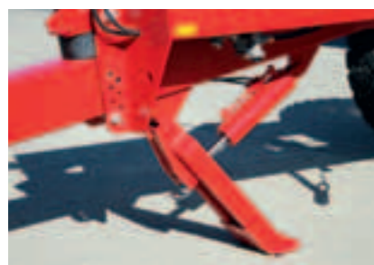
Hydraulischer Schleppfuß mit doppelwirkendem Zylinder, hoher Bodenfreiheit und großer Fußplatte.
