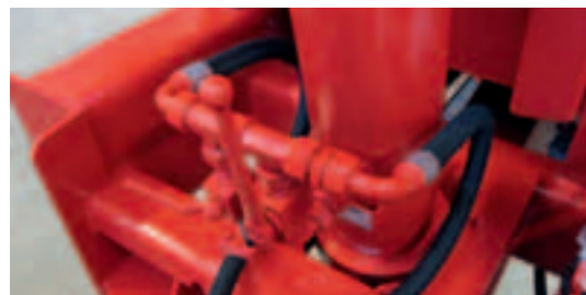
Schnellabsenkung mit 2-Schlauch-System.
