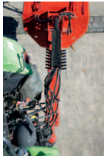
Alle Zugvorrichtungen bei Krampe sind extrem schmal gebaut, Garant für einen großen Einschlagwinkel.
