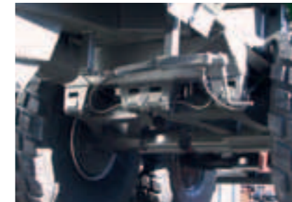
Eine typische Krampe-Innovation: Achsen mit echter Einzelradaufhängung, zuschaltbare Federung über Stickstoffspeicher.
