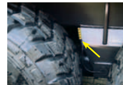
Mit der serienmäßigen Zentralschmierleiste erreichen Sie auch schwer zugängliche Schmierstellen am Pendelaggregat oder bei der hydraulischen Einzelradfederung.
