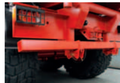
Klappbarer Unterfahrerschutz mit großer Bodenfreiheit bei aufgeklapptem Unterfahrerschutz, Schutzgitter für Rückleuchten.
