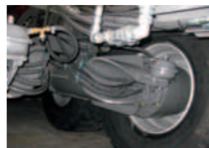
Standfestes Pendelaggregat mit hydraulischem Radantrieb.
