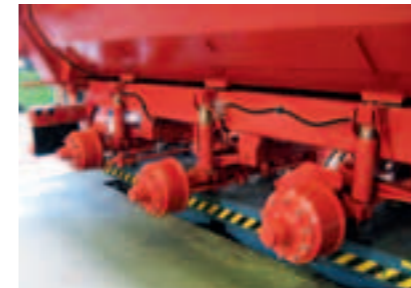
Seit vielen Jahren verfügt Krampe über Erfahrungen im Bau hydraulischer Fahrwerke. Die großen Federwege garantieren beste Fahreigenschaften auch in unebenem Gelände. Die Standsicherheit ist konkurrenzlos. Liftachsen oder eine Niveauregelung sind als Option möglich.
