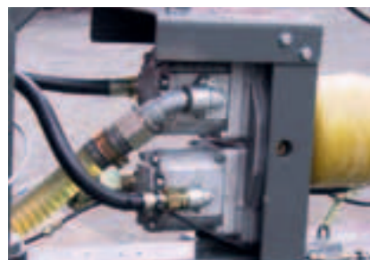
Geschwindigkeit ist (k)eine Hexerei. Von 0 auf 55° in weniger als 30 Sekunden durch diese Tandempumpe bei Zapfwelendrehzahl 900 1/min (HP 30).
