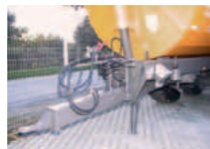
Hydraulisch höhenverstellbare Zugvorrichtung, Federung über Stickstoffspeicher.
