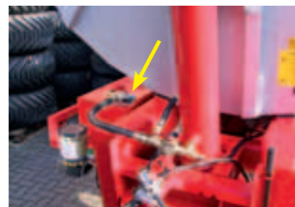
Für ganz Eilige gibt es ein elektrisch betätigtes Schnellsenkenventil. Es führt das Hydrauliköl in den Öltank des Kippers bzw. in den drucklosen Rücklauf der Zugmaschine zurück.
