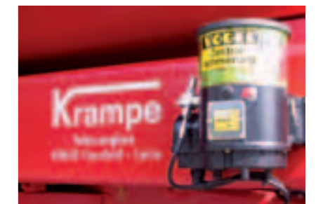
Zentralschmierung (Option). Damit werden alle Schmierstellen automatisch mit Fett versorgt, auch an schwer zugänglichen Stellen, z.B. Lenkachsen.
