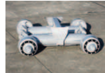
Pendelaggregat, Achsen asymmetrisch versetzt, ungefedert, speziell für Sand- und Kieskipper, selbstreinigend durch runde Pendelarme. Gute Standfestigkeit im Gelände. Achslastverteilung 45/55%.
