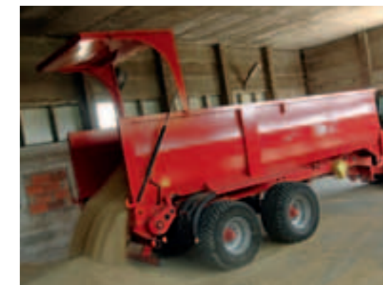
Ein Entladen in niedrigen Hallen ist möglich.
