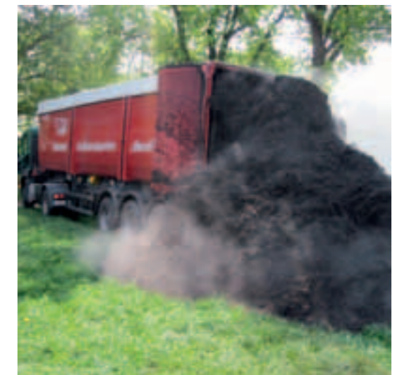
Beim abgeschobenen Ladegut wird ein sehr hoher Berg hinterlassen, die Ladung wird förmlich aus dem Sattelaufleger herausgepresst.
