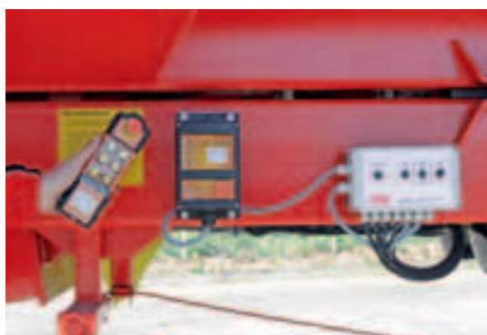
Standard: Funkfernbedienung mit Hand- und Automatikfunktion. Ebenso Standard: Eine Notbedienfunktion ist in der Verteilerkiste untergebracht.
