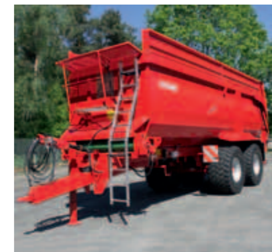
Praktisch: Die großen Sichtfenster in der Stirnwand und die klappbare Frontwand. Serie: Arbeitsbühne mit Aluminiumleiter.
