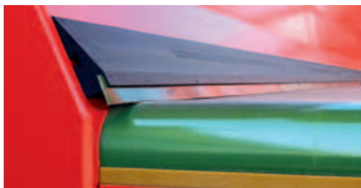
Verschleißfeste Dichtlippen an den seitlichen Bordwänden machen den Aufbau getreidedicht.
