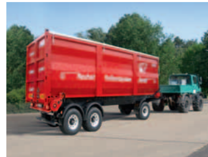
Der Rollbandwagen ist auch als Drehschemelanhängler mit 24 t zul. Gesamtgewicht lieferbar.
