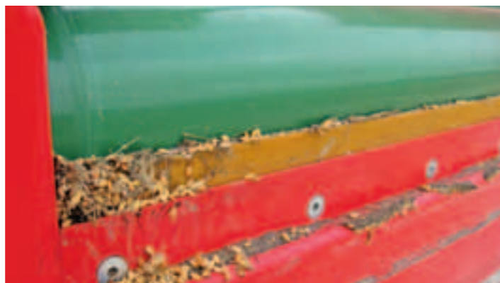
Die Abstreifer sorgen für die Reinigung des Bandes.
