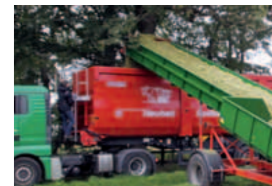
Ein hydraulisch angetriebenes Überladeband kann die Schnittstelle Acker/Straße lösen.
