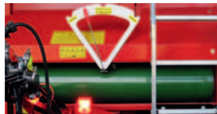
Eine mechanische Bandanzeige signalisiert den Aufwickelzustand des Bandes (Option).
