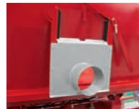
Rohrstützen für den Auslaufschieber.
