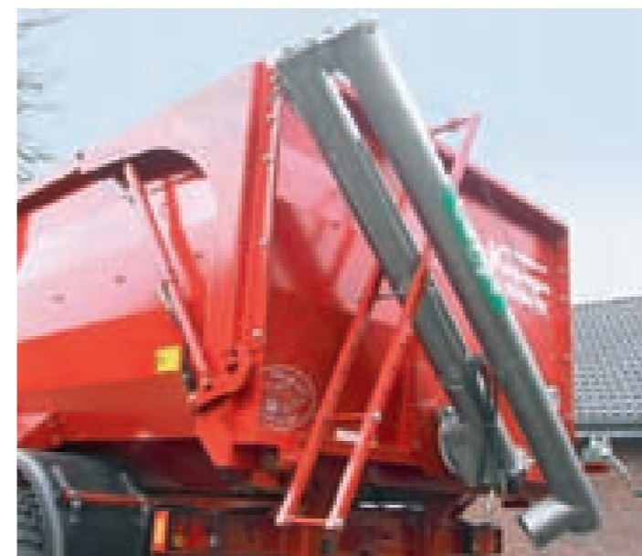
Schnecke mit seitlicher Abgabe und Leistungen von 20 bis 300t/h.
