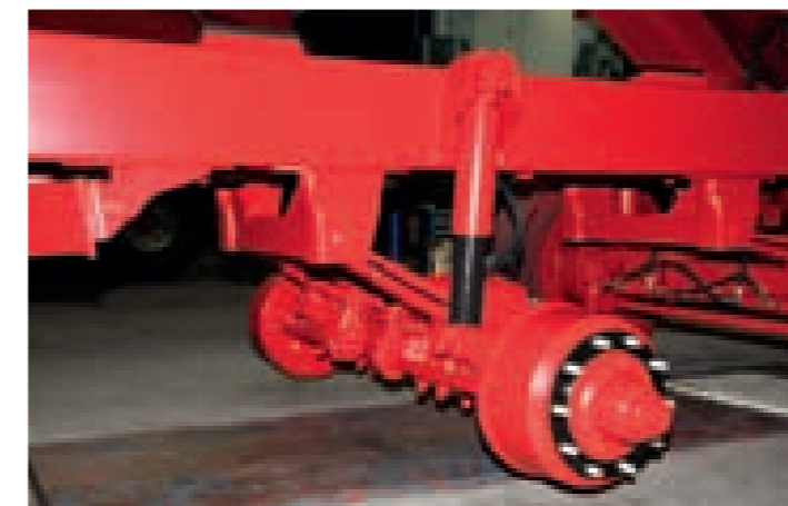
24 t Parabelfedern mit Längskernen, Achsabstand 1,55 m.
