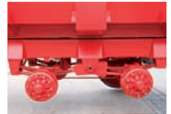
24 t Parabelfedern mit Längskernen, Achsabstand 1,55 m.
